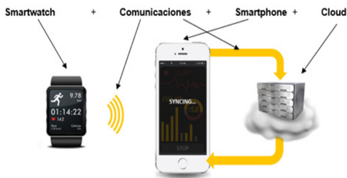
Ilustración 1. Ejemplo de sistema de IoT para dispositivos de tipo Smartwatch. Fuente: Elaboración propia.
